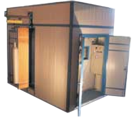
Woikoski on hankkinut Finnblastilta raepuhalluslaitteen kaasupullojen puhdistukseen
